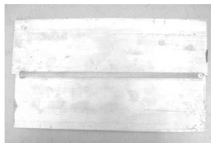
图 1 焊接完的 6005A-T4 铝合金板
